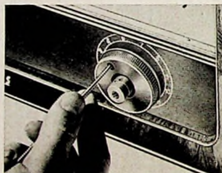
Das Nachstimmen des Oszillators bei den Philips-Fernsehgeräten der Serie „Krefeld“ wird nach Abziehen des Kanalwählerknopfes mit einem Trimm-schlüssel (etwa 2½ mm Durchmesser) vorgenommen
